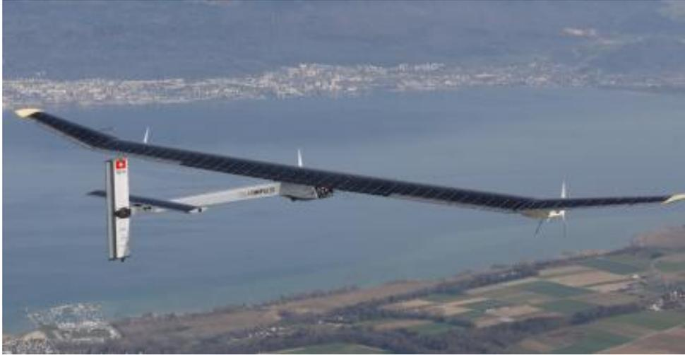
L'aereo è dotato di **12 mila celle solari** sulle ali e sugli stabilizzatori orizzontali di coda. Le celle alimentano **2 motori elettrici** per volare a una quota media di 2.000 metri. I motori, con le batterie al litio (usate per alimentare i motori di notte), sono stati fissati sotto le ali.
