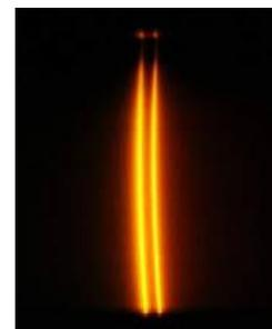
"Saggio alla fiamma" del sodio e la sua luce separata da un reticolo di diffrazione, che evidenzia il doppietto.
